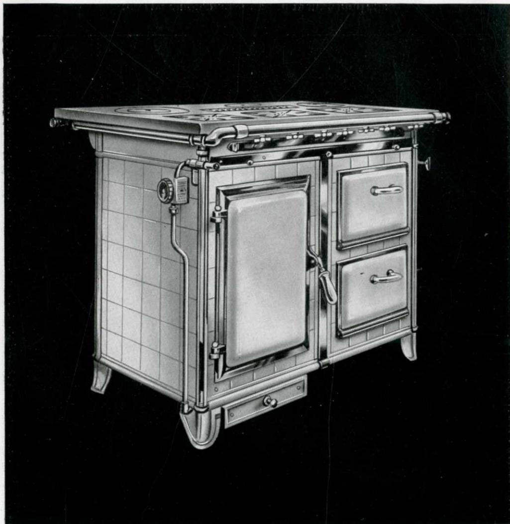
Dessus en fonte polie, alimenté par 2 brûleurs isoblocs grand modèle, 2 brûleurs isoblocs standard, un brûleur triple très puissant, 1 brûleur poissonnière. Grand coffre à rôtir muni d'un thermostat de précision. Grillade au-dessus. 1 petit four en haut et à droite avec brûleur de four et brûleur de grillade. 1 petit four en bas et à droite avec brûleur de four.
